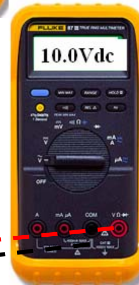
DC Voltage Meter
